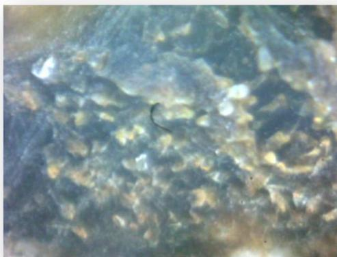
**Figura 5.10** Imagen tomada de la superficie del electrodo de HOPG, una vez aplicado un potencial de -950 mV durante 10 s.
