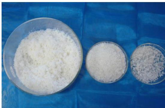
**Figura 4.3-2** Polisacárido seco triturado obtenido de la extracción de la cáscara de tuna.
