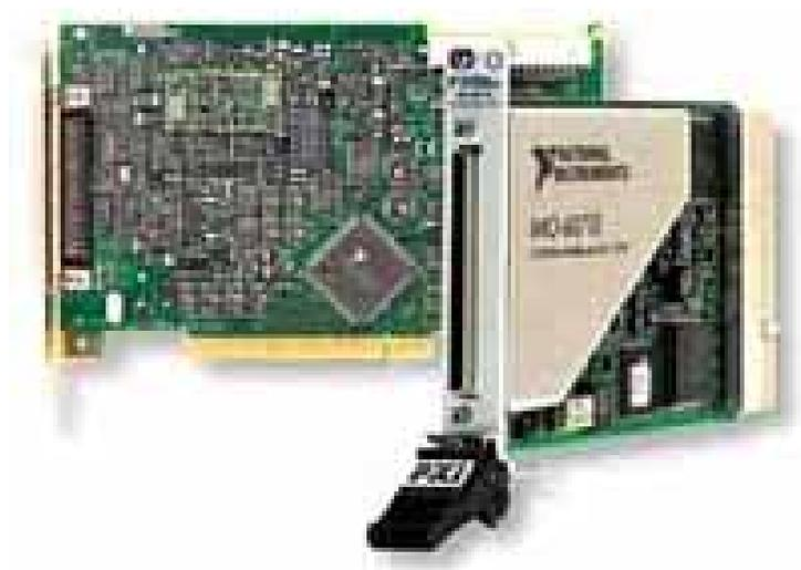
Figura C.2: Tarjeta de adquisición de datos *PCI* – 6071.
