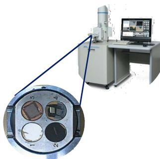
**Figura 11.-** Microscopio JEOL JSM 6010LA *Analytical Scanning Electron Microscope*, se ilustra el porta muestras utilizado en este trabajo.
