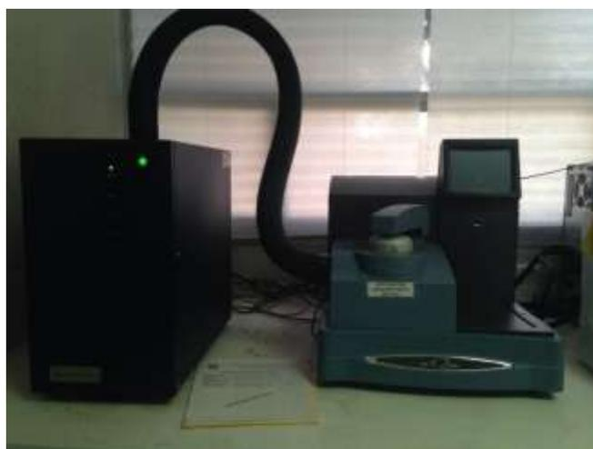
**Figura 7.** Equipo DSC serie Q2000 instrumentos TA.
