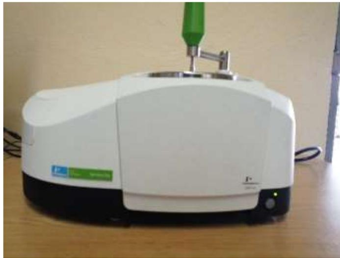
**Figura 8.** Espectrofotómetro Perkin Elmer Spectrum UATR Two.
