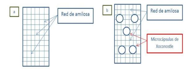
Figura 32. Esquematización del posible acomodo de componentes de las películas de almidón.
