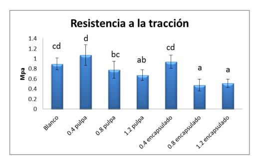
Figura 31. Resultados para resistencia a la tracción en películas de almidón de chayotextle adicionadas con xoconostle.
