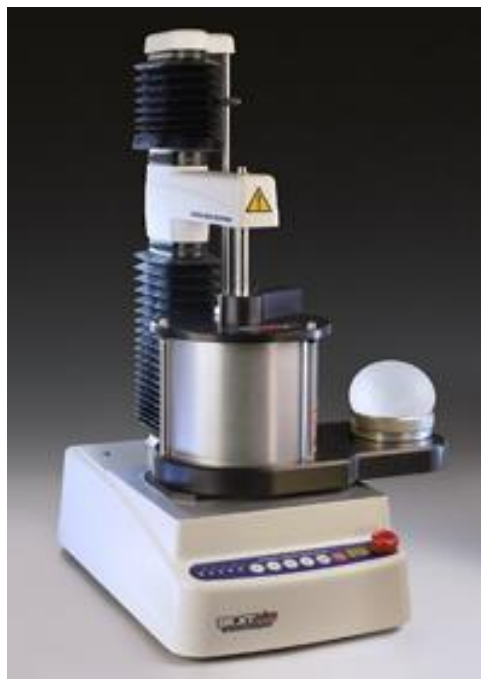
Figura 29. Sistema Dough Inflation
