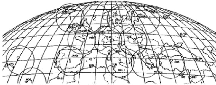
Figura. 3.16 Reutilización de frecuencias de una antena multihaz. [25]
