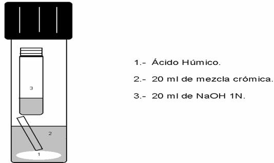
Figura 7. Esquema para la determinación de CT.
