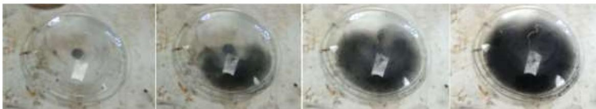
**Figura 2.17.** Evolución del óxido de grafeno (GO) a óxido de grafeno reducido (GO<sub>r</sub>).
