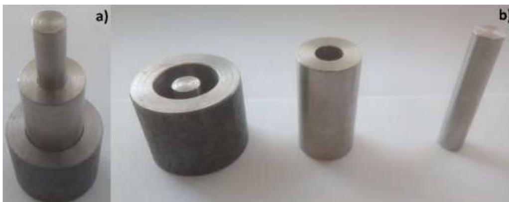
**Figura 2.15.** Dispositivo para obtención de pastillas de GO.
