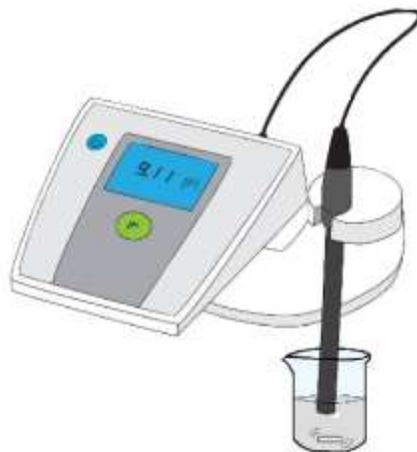
**Figura 2.4.** Medición de pH.
