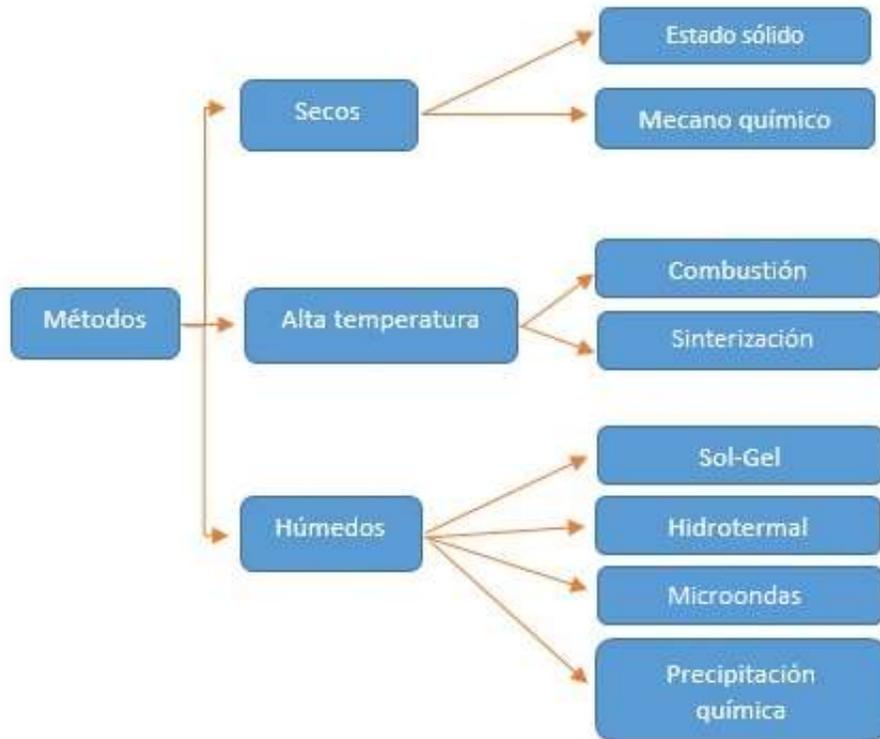
**Figura 1.5.** Métodos de obtención de HAp [38].
