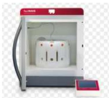
**Figura 2.5.** Horno de microondas de alta potencia.
