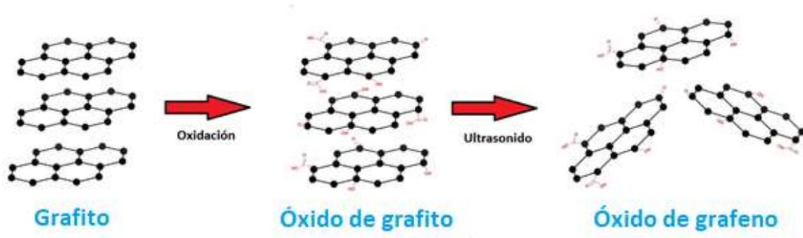
**Figura 1.25.** Preparación de láminas de óxido de grafeno a partir de grafito.
