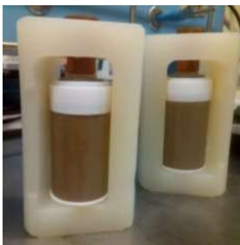
**Figura 2.19** Reactores de síntesis para el uso en microondas.
