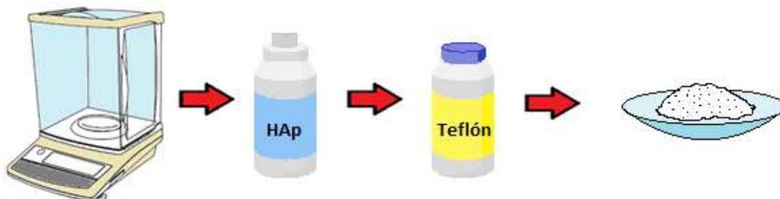
**Figura 2.7.** Obtención de polvo de HAp + Teflón
