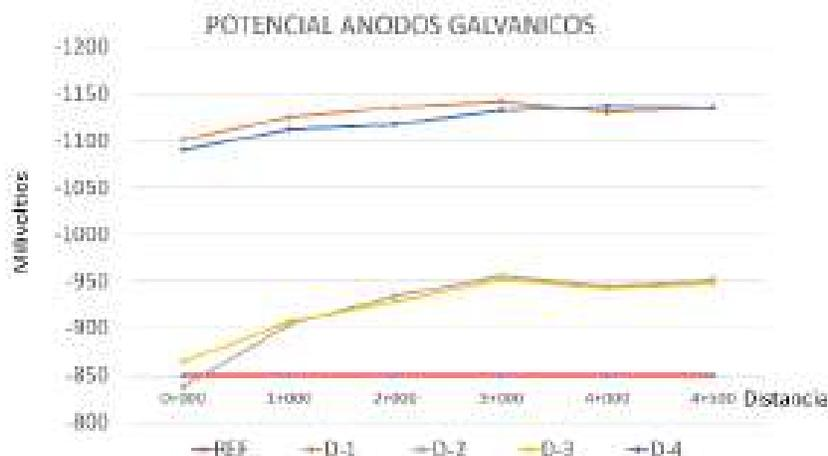
Figura 7. Cobertura de protección catódica por corriente impresa
