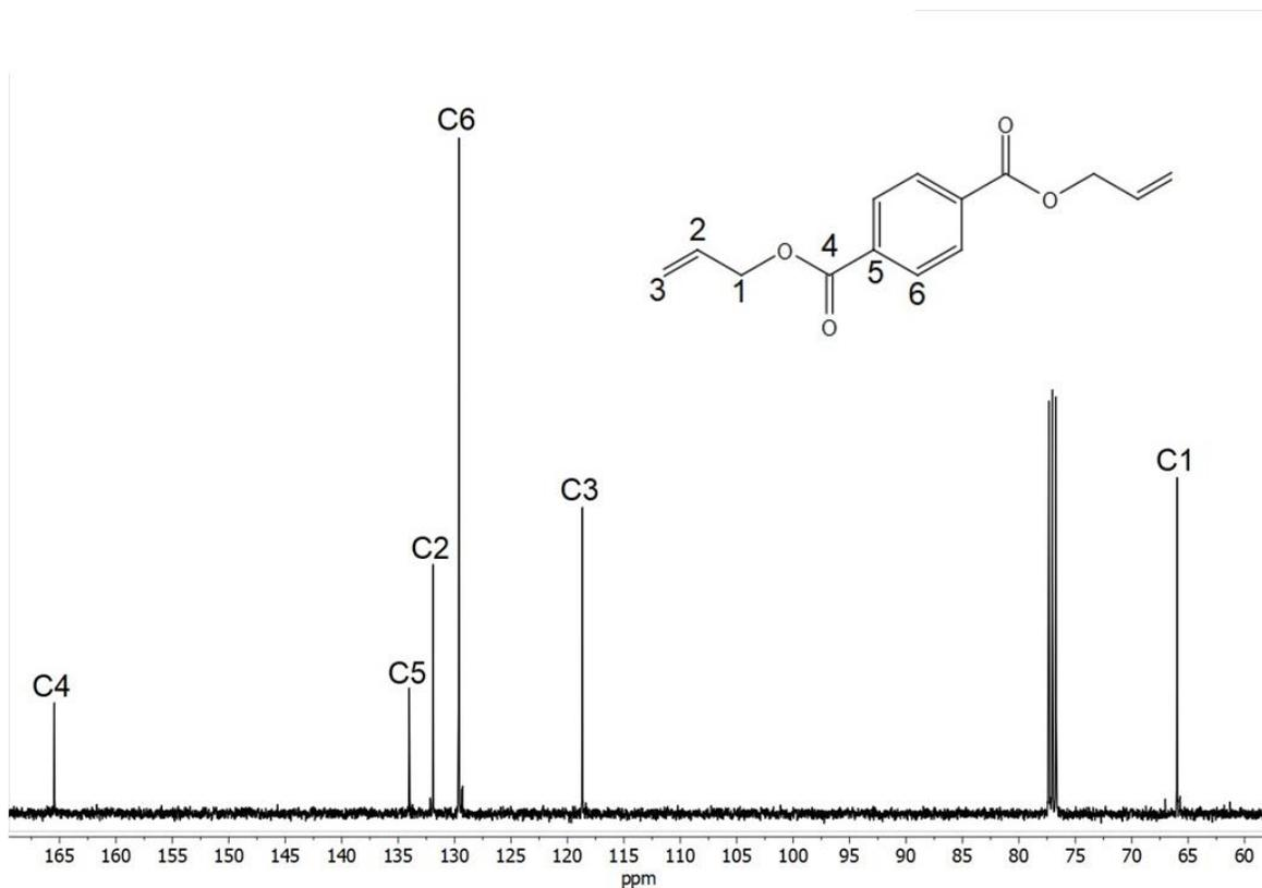
**Figura 3.33.** Espectro de RMN de  $^{13}\text{C}$  del tereftalato de dialilo.
