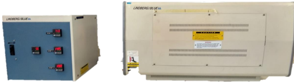
Figura 4.3. Horno tubular de tres zonas Lindberg/Blue.
