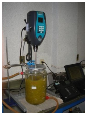
Figura 15. Montaje experimental del proceso de extracción de polisacáridos pécticos de tuna. Tanque agitado enchaquetado acoplado a un agitador Lightning® con control de agitación y sonda de temperatura.
