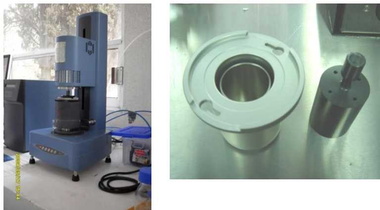
Figura 18. Reómetro de esfuerzo controlado TA Instruments AR2000 y geometría de cilindros concéntricos de doble pared usados en esta investigación.
