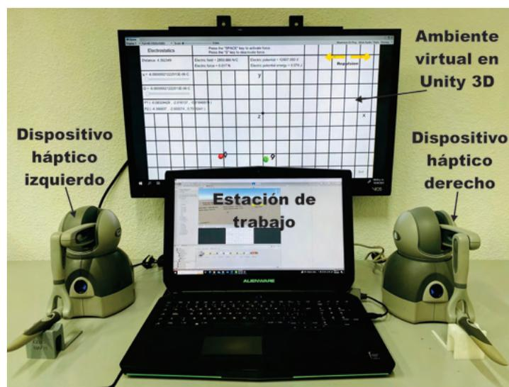
Figura 4.77: Sistema cooperativo HRpI para la enseñanza de la electrostática.
