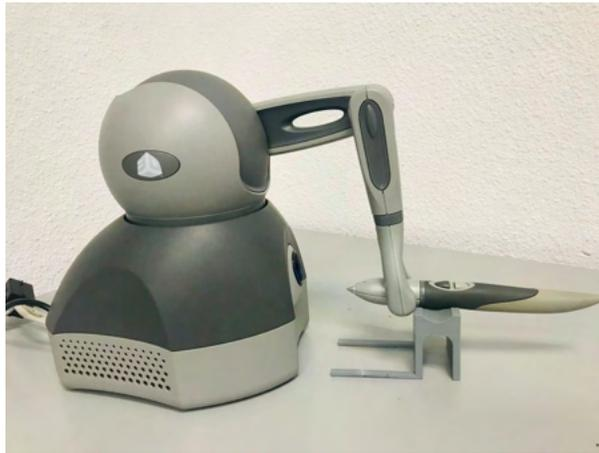
Figura 2.1: Dispositivo háptico Geomagic Touch [157].
