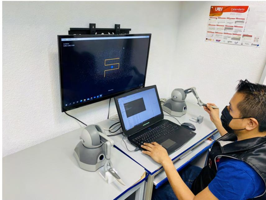
Figura 3.34: Plataforma de entrenamiento háptico: Laberinto.
