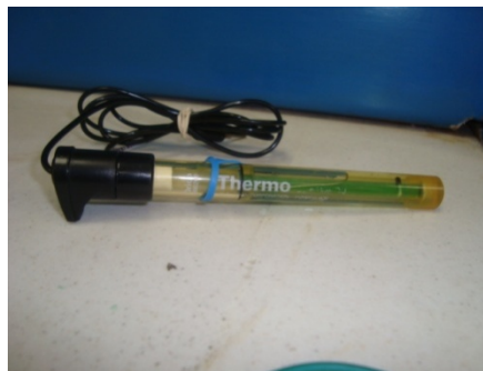
Figura 3.5. Electrodo de referencia utilizados. Izquierda: hidratación previa a su uso.
