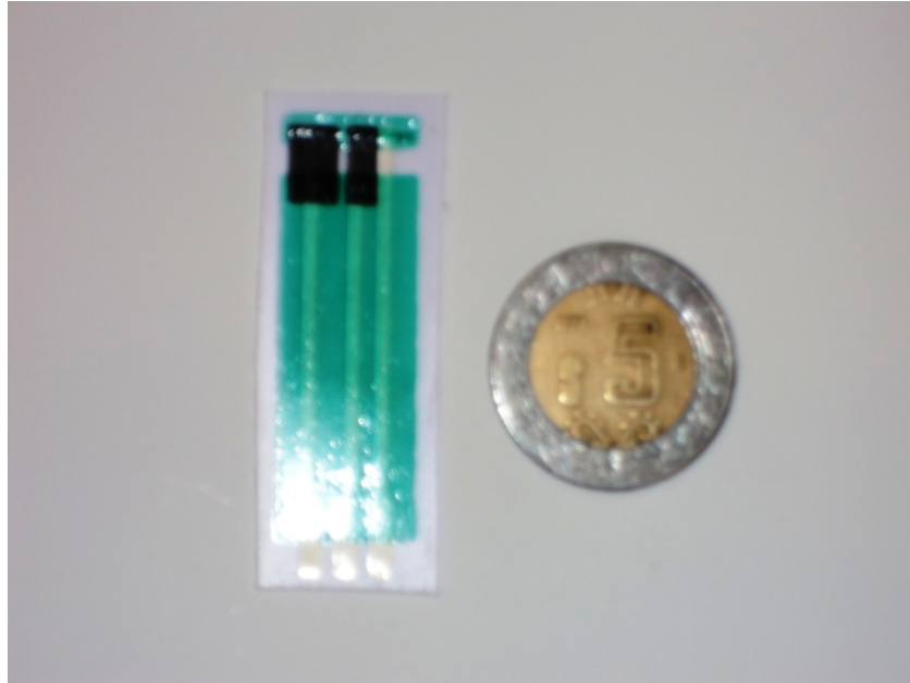
Figura 3.4. Sensores electroquímicos en configuración plana.
