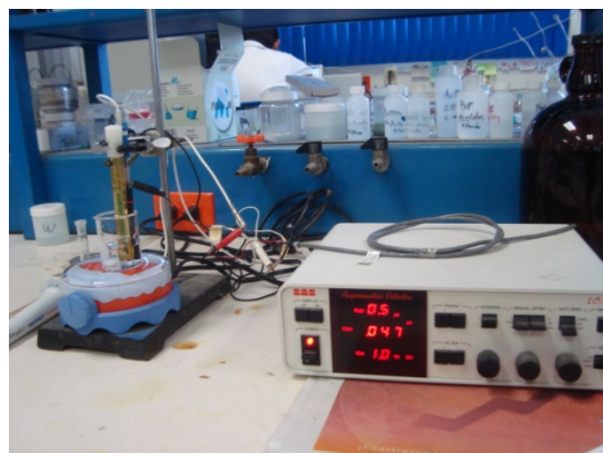
Figura 3.12. Detector amperométrico BAS LC-4C de laboratorio de electroquímica.
