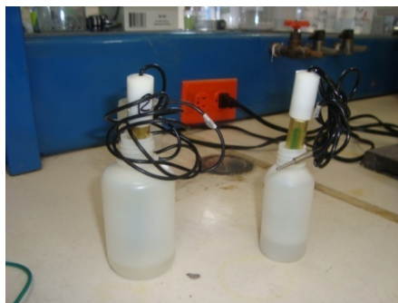
Figura 3.5. Electrodo de referencia utilizados. Izquierda: hidratación previa a su uso.
