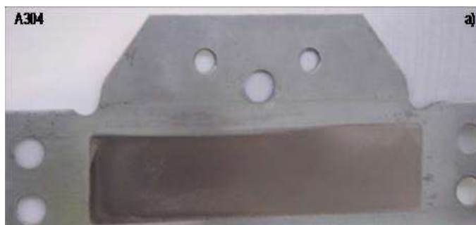
Figura 10. Depósito obtenido sobre el electrodo de acero inoxidable A304 después de realizar la macroelectrólisis de la solución DSFR a un potencial controlado de 250 mV.
