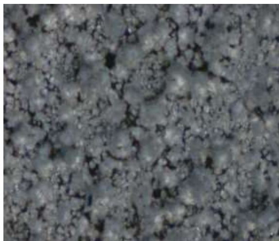
Figura 39. Depósito obtenidos sobre el electrodo de titanio ( \text{área } 64.3 \text{ cm}^2 ) después de realizar el estudio cronopotenciométricos a una corriente constante de -150 mA y una velocidad de flujo de 15 \text{ Lmin}^{-1} . Tempo de electrólisis de 210 minutos.
