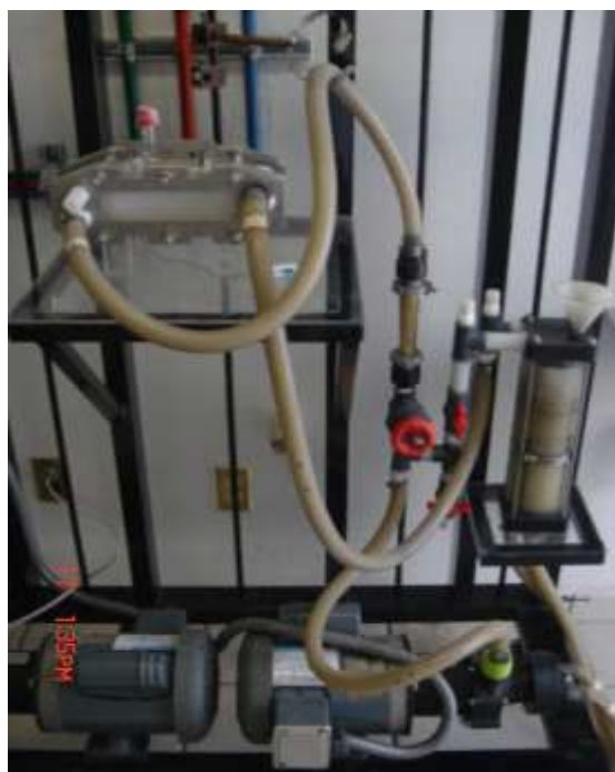
Figura 5. Sistema hidráulico: recipientes, bombas y puertos de muestreo, utilizados en la realización de los estudios de macroelectrólisis.
