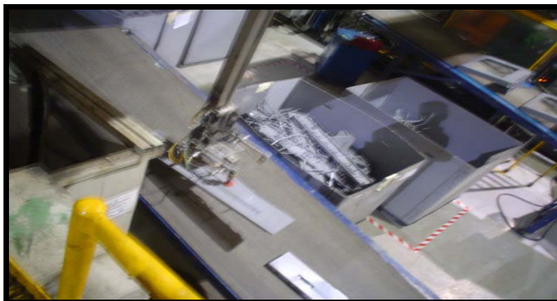
Figura III.14. Brazo del robot colocando la pieza en banda transportadora. Fuente: Manufacturas Avanzadas, 2006.
