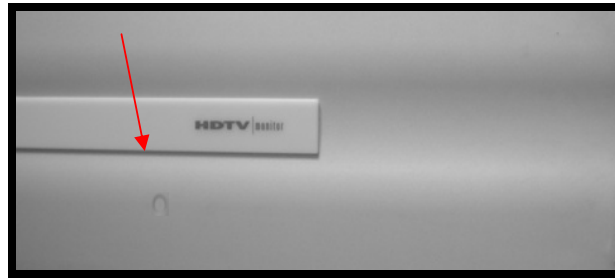
Figura III.20. Pieza con hundimiento combinación (-1, 1, 1). Fuente: Manufacturas Avanzadas, 2006.
