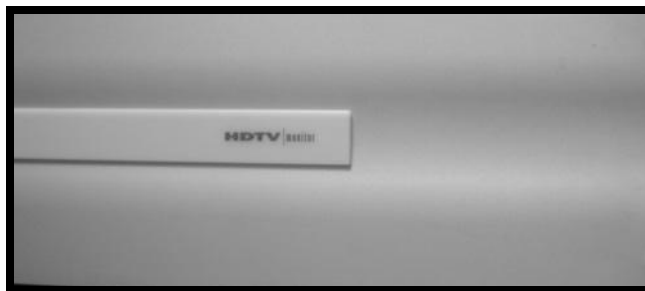
Figura III.21. Pieza sin hundimiento combinación (1, 1, -1). Fuente: Manufacturas Avanzadas, 2006.
