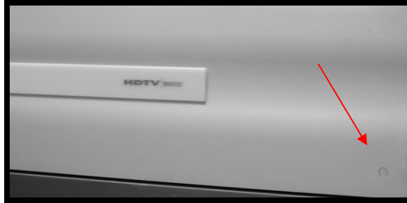
Figura III.17. Pieza con hundimiento combinación (-1, -1, -1). Fuente: Manufacturas Avanzadas, 2006.
