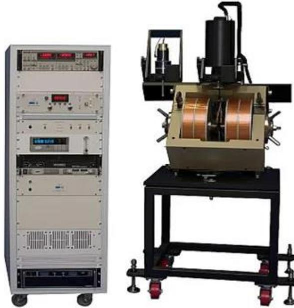
**Figura 3.5** Magnetómetro de muestra vibrante EV7.
