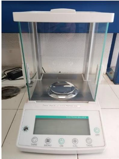
**Figura 3.1** foto de la balanza analítica.
