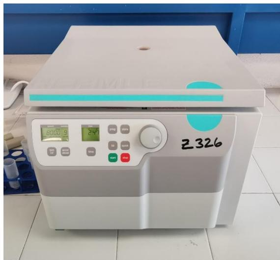
**Figura 3.8** Centrifugadora Hermle Laboratechnik Z326.
