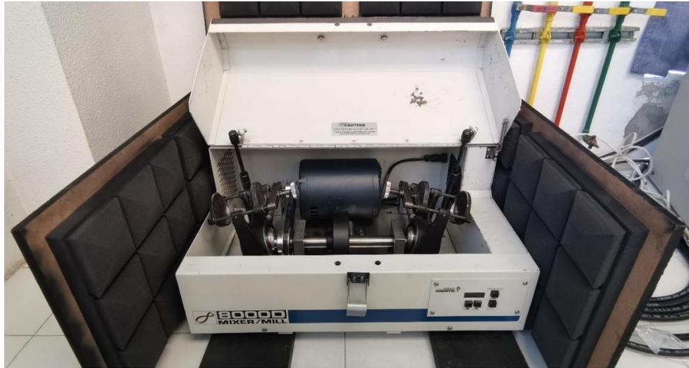
**Figura 3.2** Molino de alta energía SPEX 8000D.
