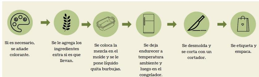
Figura 1.3: Proceso artesanal en la elaboración del jabón parte 2.
