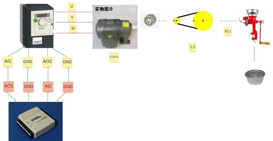
Figura 3.2: Se muestra la conexión esquemática del variador de frecuencia y la tarjeta DAQ 6008.
