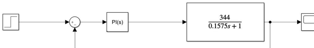
Figura 3.5: Diagrama de bloques en lazo cerrado
