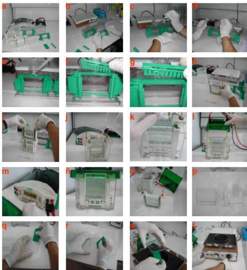
**Figura 3.** Montaje del equipo de electroforesis. a) material de electroforesis vertical; b) Montaje del equipo; c-d) Preparación del gel separador y gel concentrador; e-g) h-ñ) electroforesis; o-s) Tinción del gel; t) Desteñido de gel. (Autores: Jesús V. Jorrín Novo y Ana María Maldonado Alconada, 2007).
