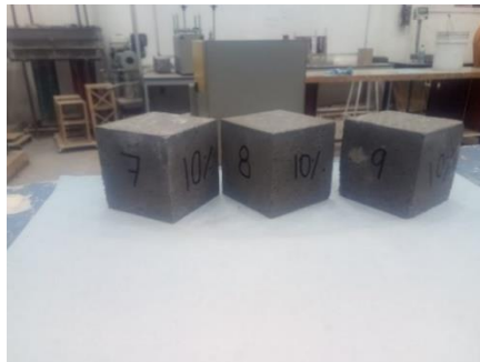
Figura 25 Especímenes para prueba de resistencia a la compresión
