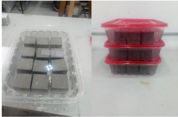
Figura 23 Curado de especímenes de 5 x 5 x 5 cm
