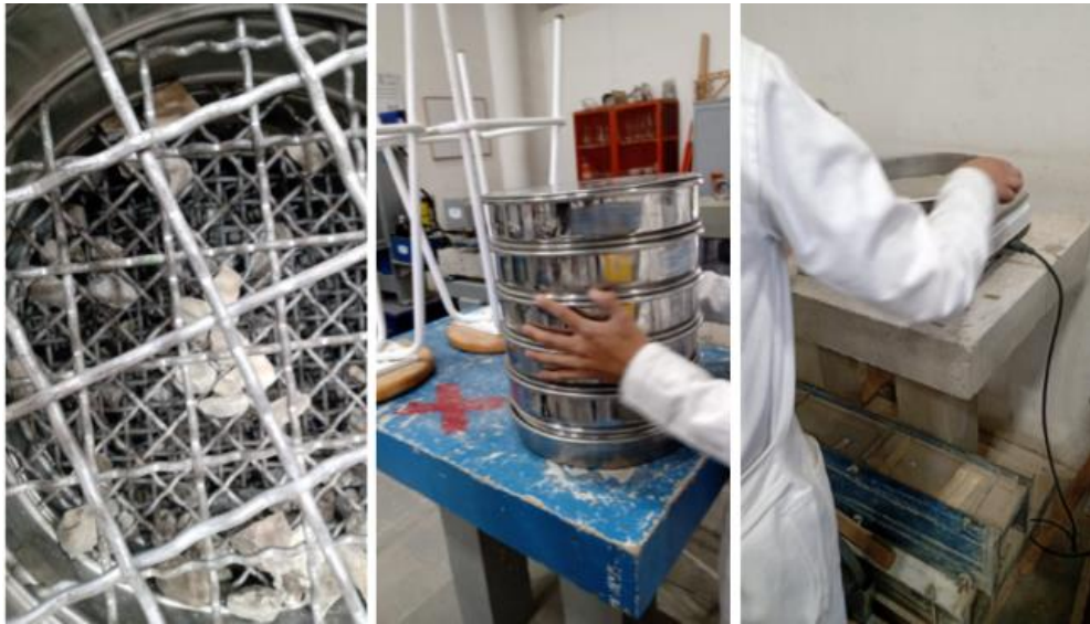
Figura 13 torre de tamices normalizados
