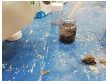
Figura 27 Muestra de mortero en alcohol isopropílico
