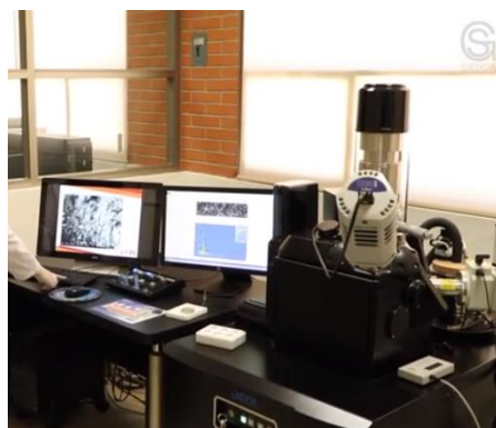
Figura 33 Microscopio Electrónico de Barrido.
