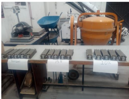
Figura 21 Preparación de cubos
