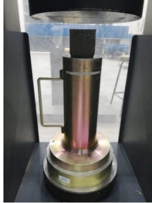
Figura 26 Prueba de resistencia a la compresión de cubos de mortero
