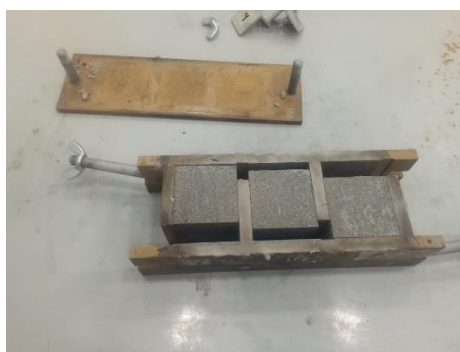
Figura 22 Desmolde de cubos
