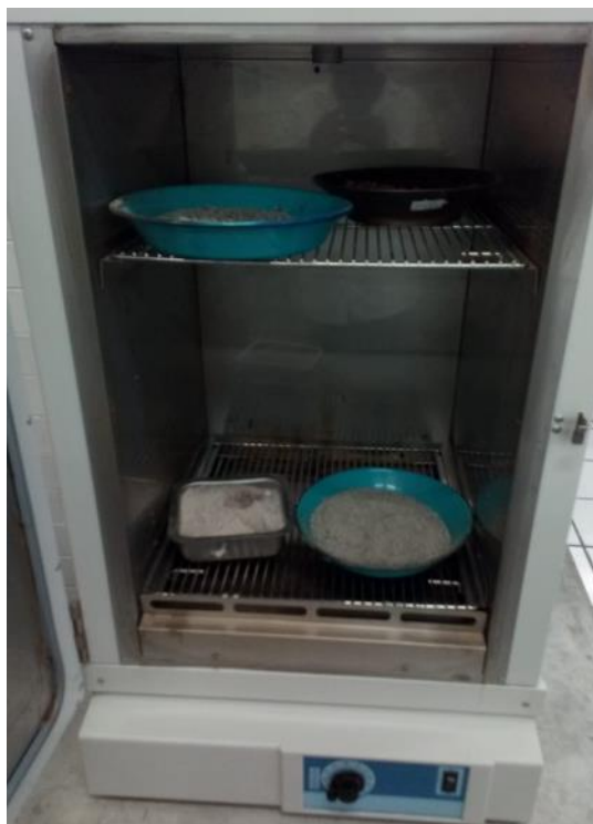
Figura 15 Secado de materiales pétreos
