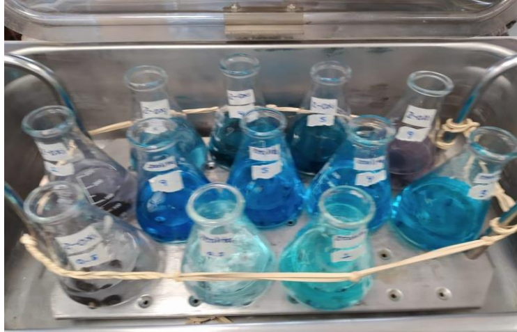
Figura 6.8. Evaluación cinética de la adsorción de azul de metileno en Fe_3O_4 -mordenita y mordenita no modificada.
