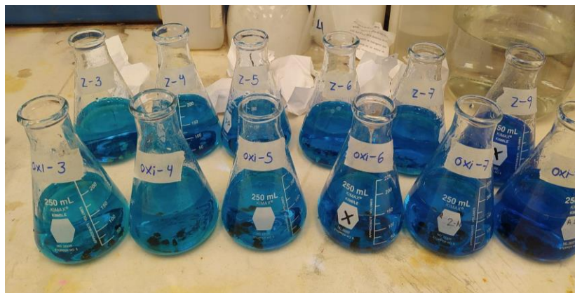
Figura 6.7. Evaluación de la adsorción de azul de metileno en \text{Fe}_3\text{O}_4 -mordenita y mordenita no modificada.
