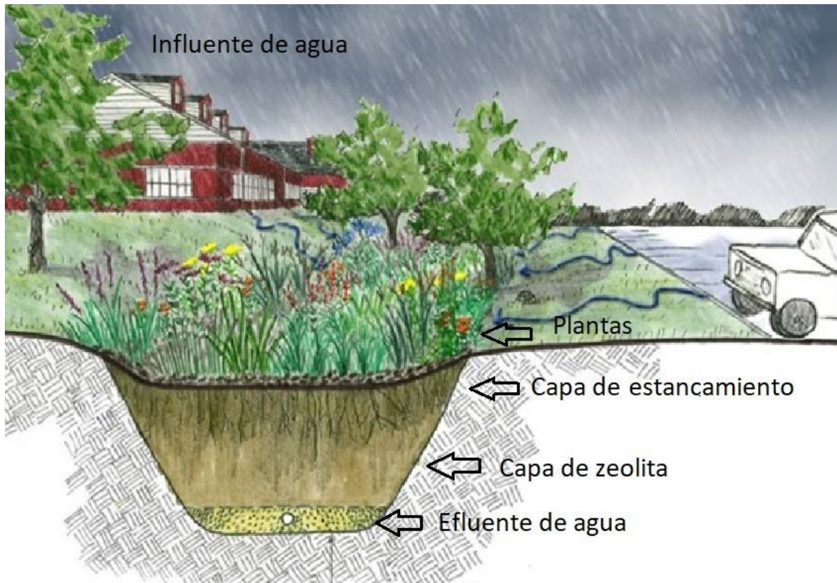
Figura 2.1 Esquema de una celda de biorretención. Fuente: Morgan M. How Rain Gardens Complement Climate Victory Gardens. https://dengarden.com/gardening/Rain-Gardens-Complement-Climate-Victory-Gardens .
