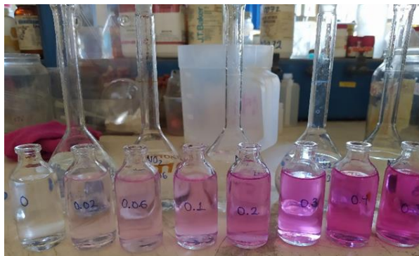
Figura 6.5. Curva de calibración correspondiente a la medición de N\text{-NO}_2^-
