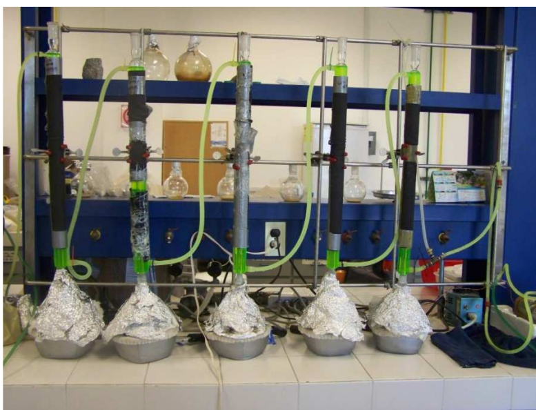
Fig. 34. Montaje del experimento: sistema de reflujo en extracción secuencial de bitumen.
