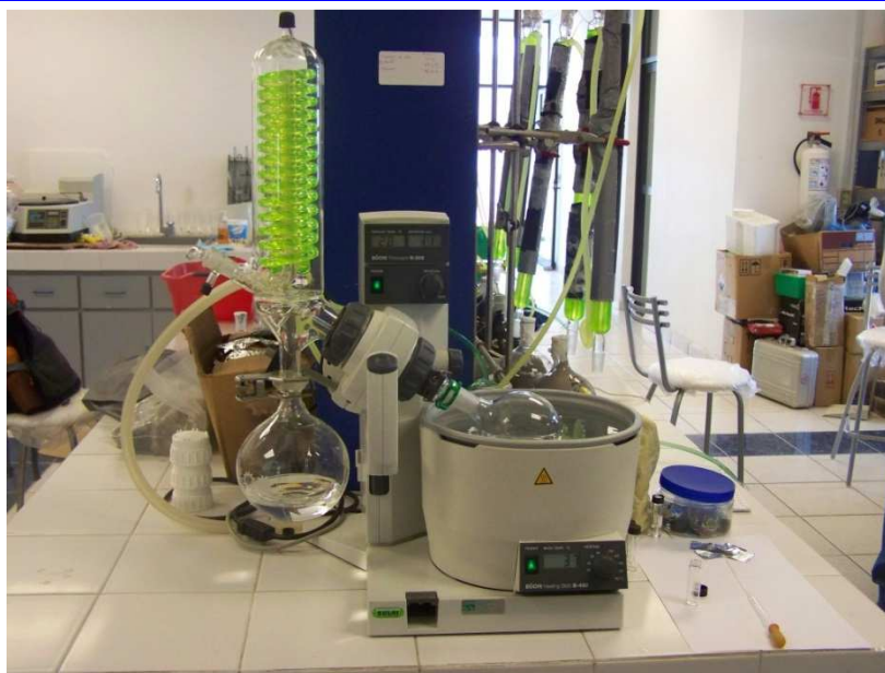
Fig. 35. Montaje del experimento: sistema de reflujo en extracción secuencial de bitumen.
