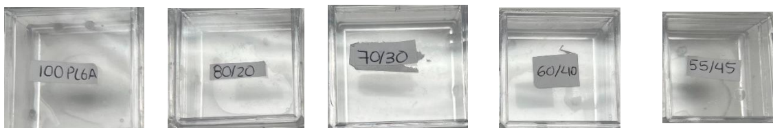
Figura 3. 12. Fotografías del comportamiento de degradación para los andamios a 100, 80/20, 70/30, 60/40 y 55/45.
