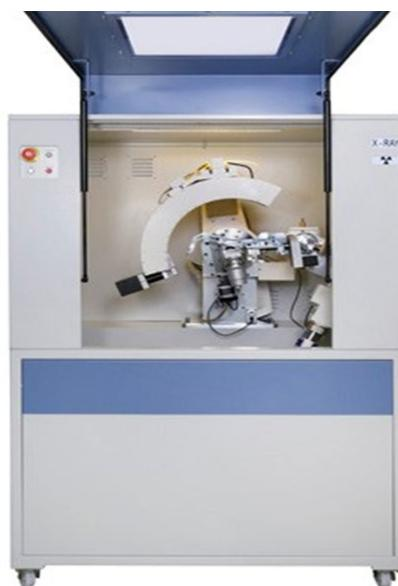
Figura 3.5 Difractómetro de rayos X Equinox 2000.
