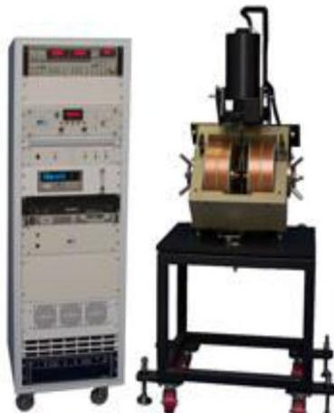
Figura 3.6 Magnetómetro de muestra vibrante.
