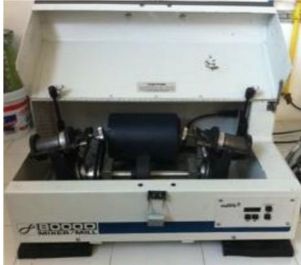
Figura 3.2 Molino de alta energía SPEX 8000D.
