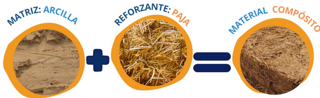
Figura 1.4 Ejemplo de material compósito formado por arcilla y paja.
