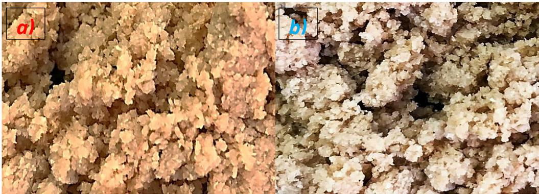
Figura 1.12. Despigmentación (a) pigmentación antes del proceso, (b) pigmentación después del proceso.
