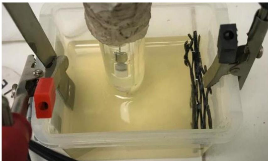
*Figura 1.21. Esquematización del Sistema electroquímico con un arreglo de 3 electrodos; (rojo) E.T, (Negro) C.E. (Blanco) Referencia.*
