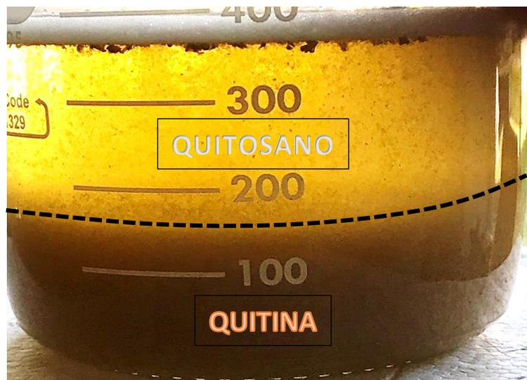
Figura 1.13. Muestra de productos del proceso de desacetilación con NaOH.
