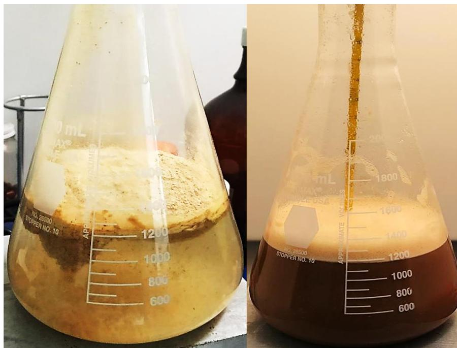
Figura 1.10. Desproteinización de la cáscara de camarón mediante NaOH.
