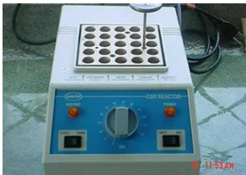
Figura 5.3 Bloque de digestión empleado para la determinación de DQO
