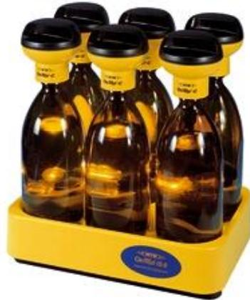
Figura 5.2 Botellas OxiTop empleadas para la medición de  $\text{DBO}_5$
