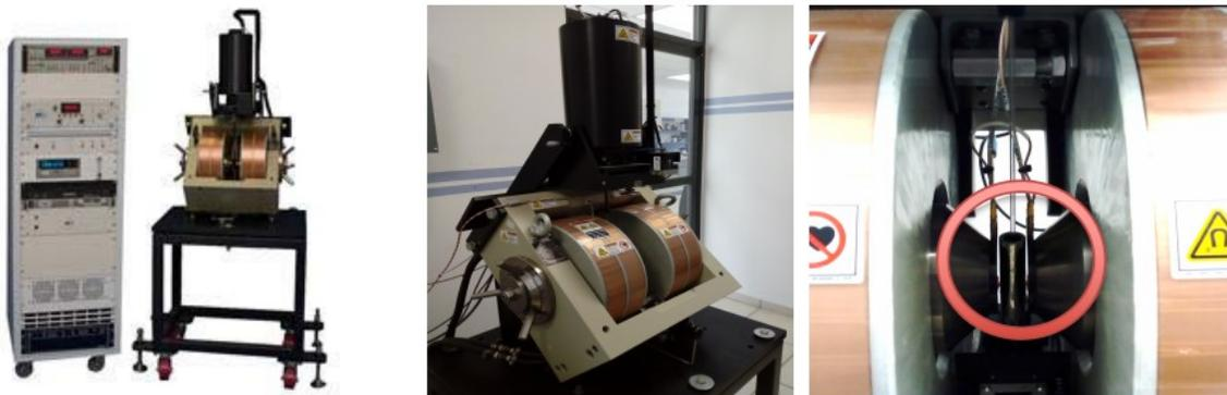
*Figura 3.5. Magnetómetro MV Micro Sense modelo EV7, las imágenes a la derecha muestran un acercamiento al equipo, haciendo visible la cámara de temperatura señalada con la circunferencia roja.*
