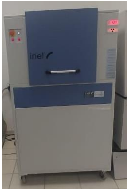
Figura 20. Difractómetro de Rayos X Equinox 2000 (INEL, Artenay, Francia) con radiación \text{CoK}\alpha_1 (1.79026 Å).
