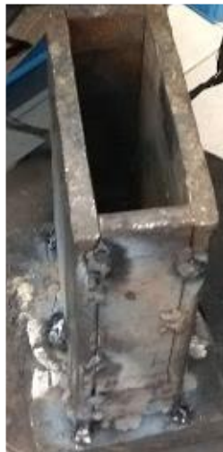
Figura 15. - Lingotera empleada para la fabricación de los aceros.
