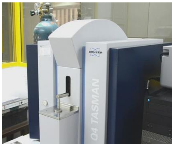
Figura 19.- Espectrómetro Bruker Tasman Q4.
