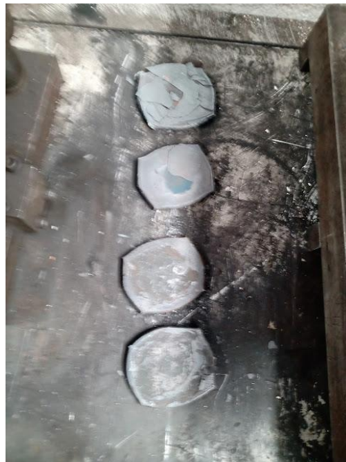
Figura 22.- Muestras deformadas en caliente durante el enfriamiento.
