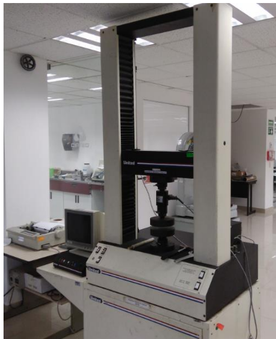
Figura 31.- Equipo Universal United STM-10-EZ para ensayos mecánicos.
