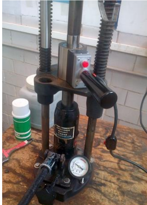
Figura 24.- Montadora manual de muestras.
