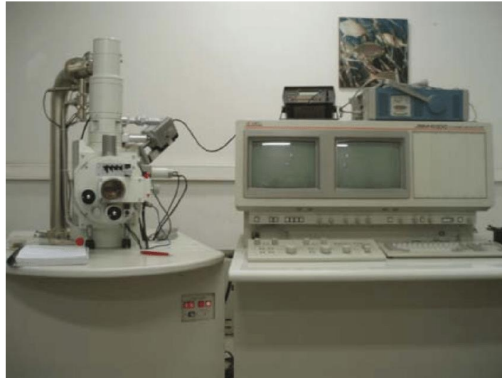
Figura 28.- Microscopio Electrónico de Barrido Jeol modelo 6300.
