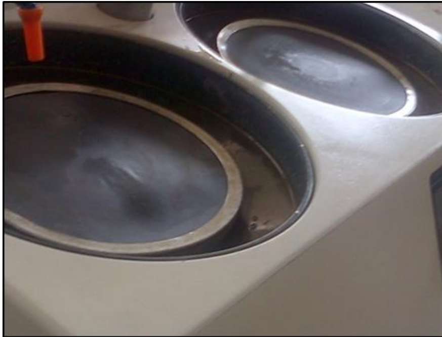
Figura 25.- Pulidora Metalográfica Buehler, Modelo máster 2000.
