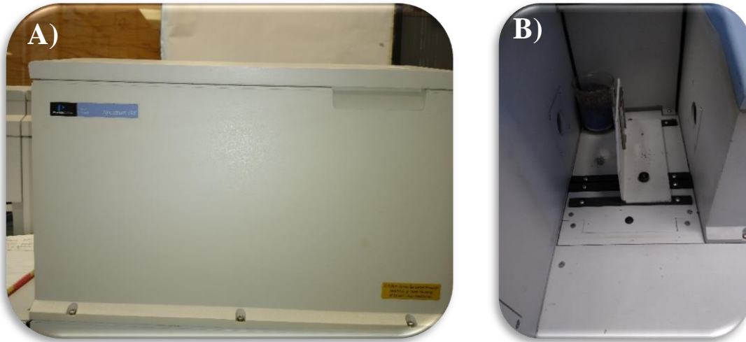
Figura 3.6 A) Equipo Infrarrojo (FTIR), marca Perkin Elmer Modelo Spectrum GX B) cámara de análisis.
