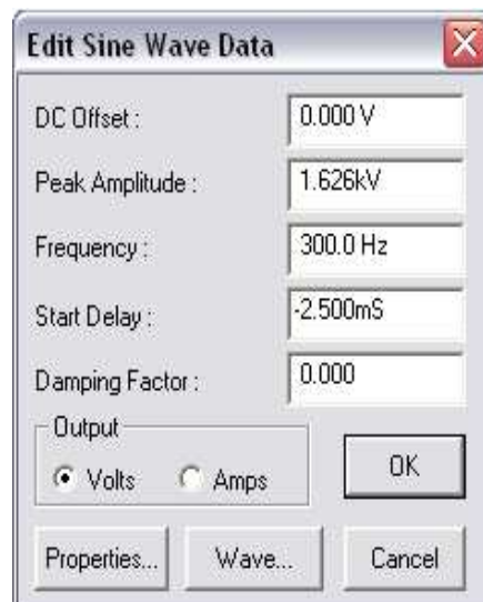
Figura 5.7: Parámetros de la Señal del Quinto Armónico.
