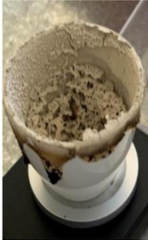
*Figura 6: Urea después de 3 horas en la mufla*
