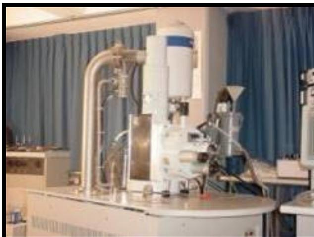
Figura 14. Microscopio electrónico de barrido.
