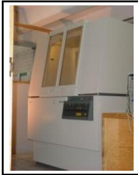
Figura 16. Difractómetro de rayos X.
