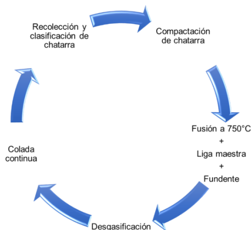
Figura 4.9. Proceso de fusión de palanquillas de Aluminio.
