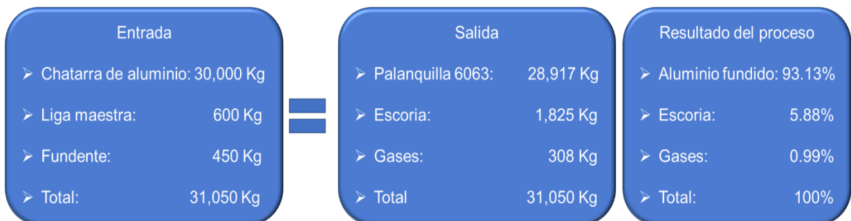
Figura 4.6 Balance de materia para el proceso de fusión
