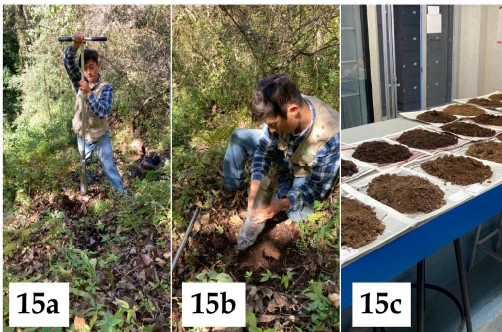
Figura 15. **15a)** Extracción de muestra de suelo; **15b)** Traslado de muestras; **15c)** Secado de las muestras
