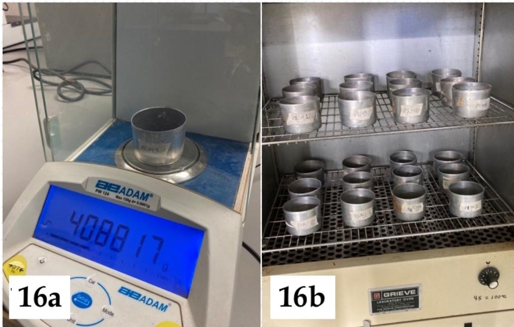
Figura 16. 17a) Pesaje de la muestra; 17b) Secado de muestras
