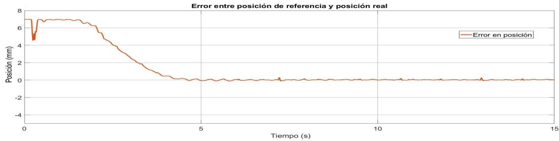
Figura 3.44: Error generado entre la referencia de posición de 7mm y la respuesta real del sistema MAGLEV con un tiempo de convergencia de 5s.
