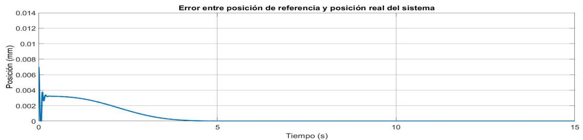
Figura 3.33: Error generado entre la referencia de posición de 7mm y la respuesta del sistema MAGLEV con un tiempo de convergencia de 5s.
