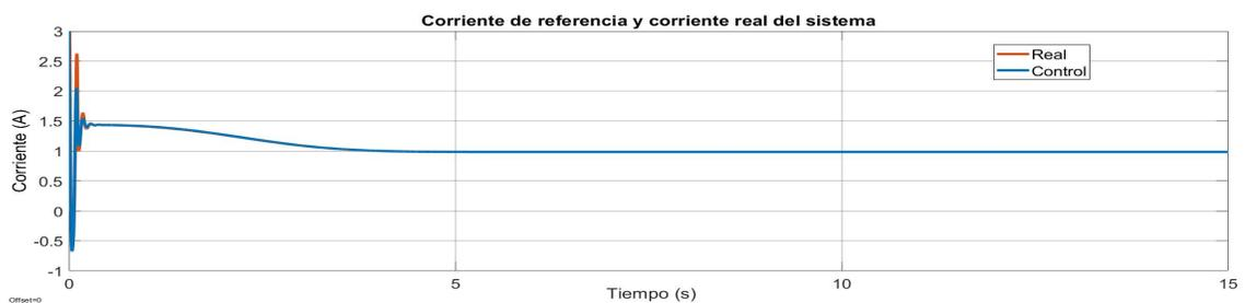
Figura 3.34: Respuesta del circuito eléctrico ante la referencia generada por la salida del control de posición.
