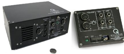
Figura 3.2: Amplificador y DAQ de Quanser.
