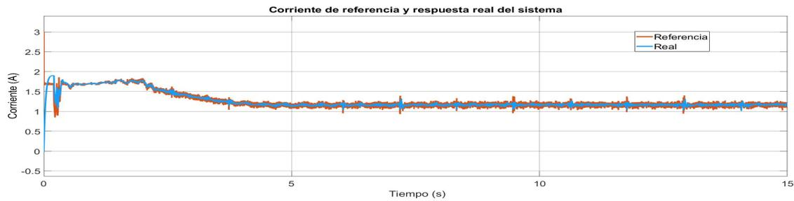
Figura 3.45: Respuesta real del circuito eléctrico ante la referencia generada por la salida del control de posición.
