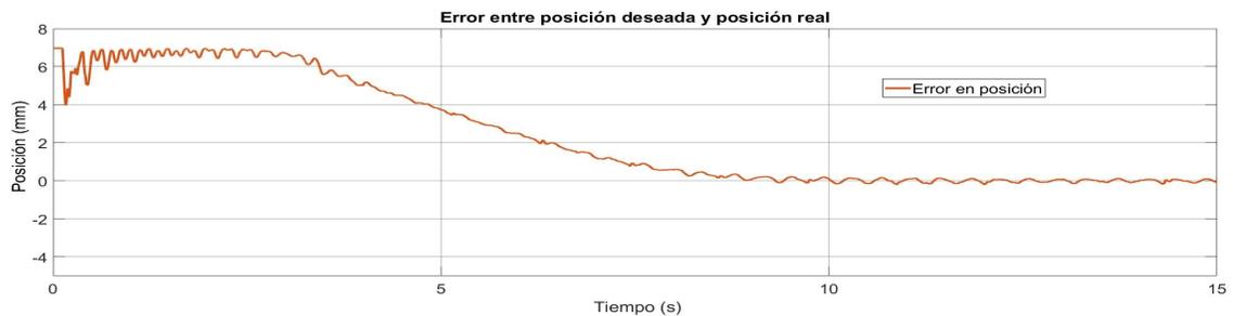
Figura 3.54: Error generado entre la referencia de posición de 7mm y la respuesta real del sistema MAGLEV con un tiempo de convergencia de 10s con una perturbación.
