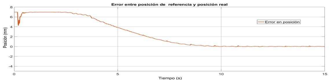
Figura 3.49: Error generado entre la referencia de posición de 7mm y la respuesta real del sistema MAGLEV con un tiempo de convergencia de 10s.
