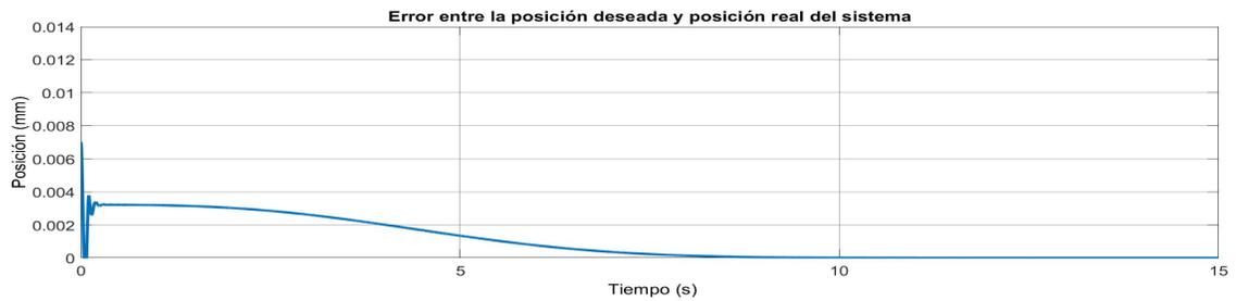
Figura 3.38: Error generado entre la referencia de posición de 7mm y la respuesta del sistema MAGLEV con un tiempo de convergencia de 10s.
