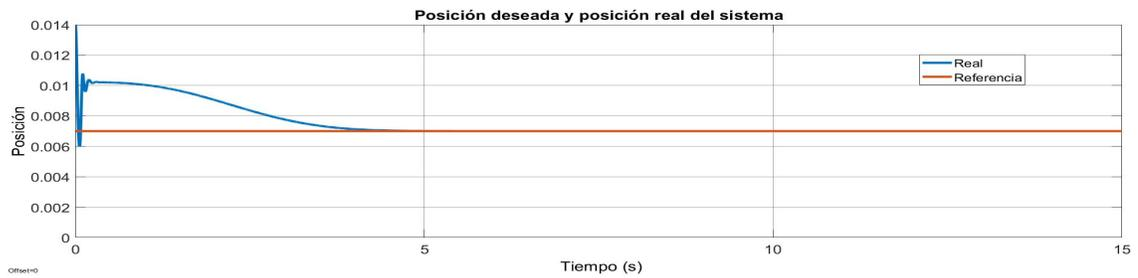
Figura 3.32: Respuesta del sistema ante una referencia de posición de 7mm y un tiempo de convergencia de 5s.
