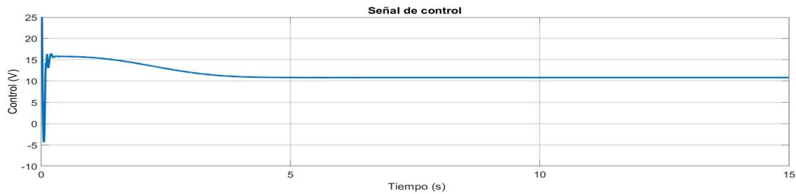
Figura 3.36: Señal de control generada por el control de corriente inyectada a la entrada del sistema MAGLEV como una señal de voltaje.
