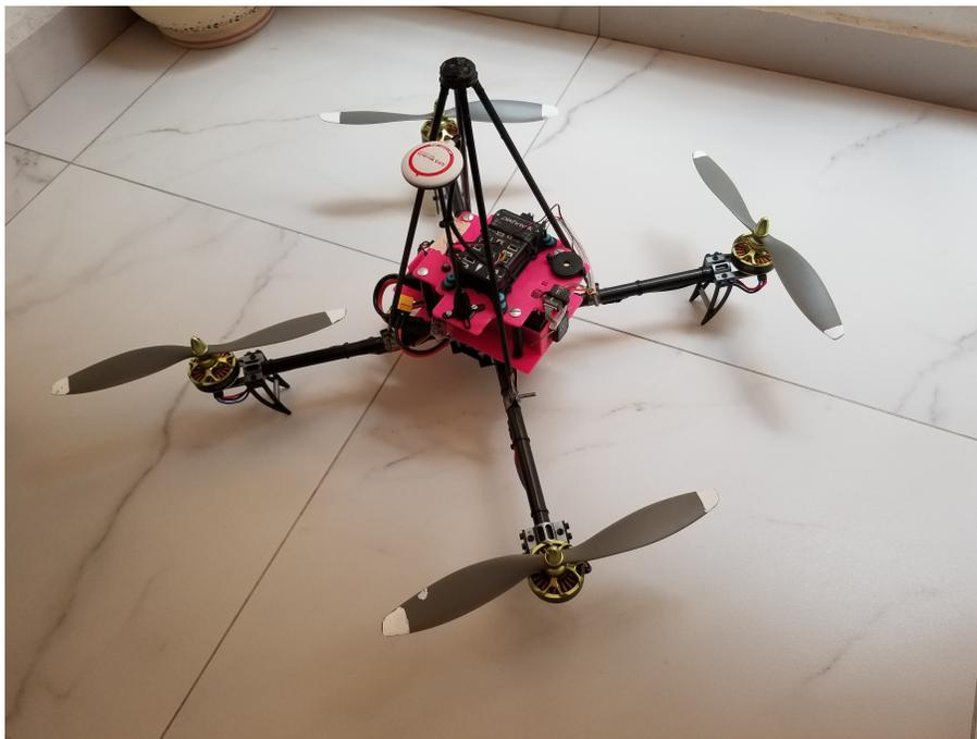
Figura 4.1: Helicóptero miniatura de cuatro rotores.
