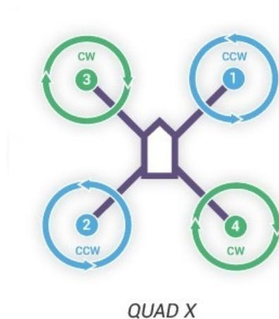
Figura 4.9: Configuración cuadrada del helicóptero miniatura de cuatro rotores.
