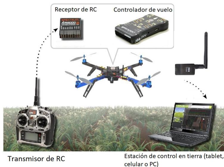
Figura 4.4: Conexión de la estación en tierra con el helicóptero miniatura de cuatro rotores.
