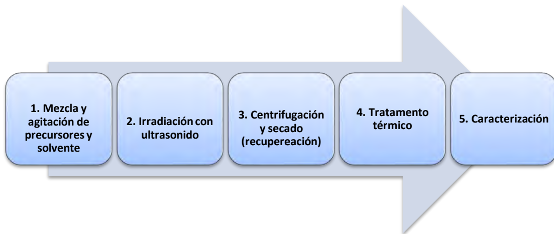
Figura 18: Método experimental para la obtención de ferritas hexagonales, cúbicas y tipo perovskita.
