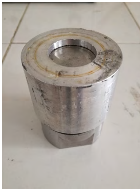
Figura 2.5: Contenedor de acero inoxidable.
