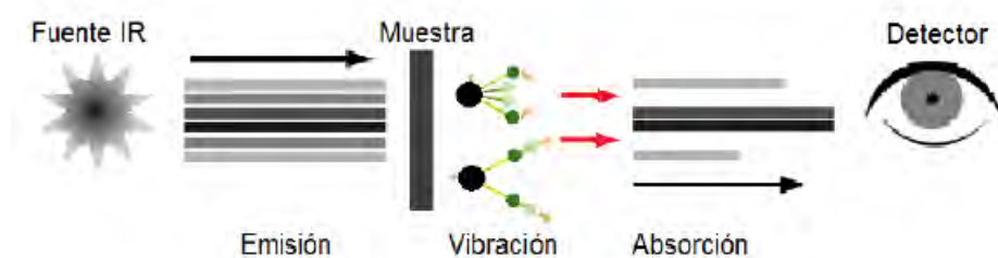
Figura 1.22: Principio de funcionamiento de las espectroscopia IR (Guerrero and Caballero, 2015)
