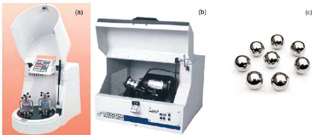
Figura 1.14: Dispositivos utilizados mecano-química (Sepelak et al. , 2012)
