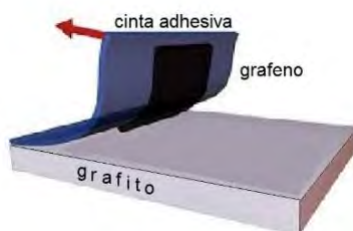
Figura 1.11: Esquema del método de Scotch Tape (Guerrero and Caballero, 2015)
