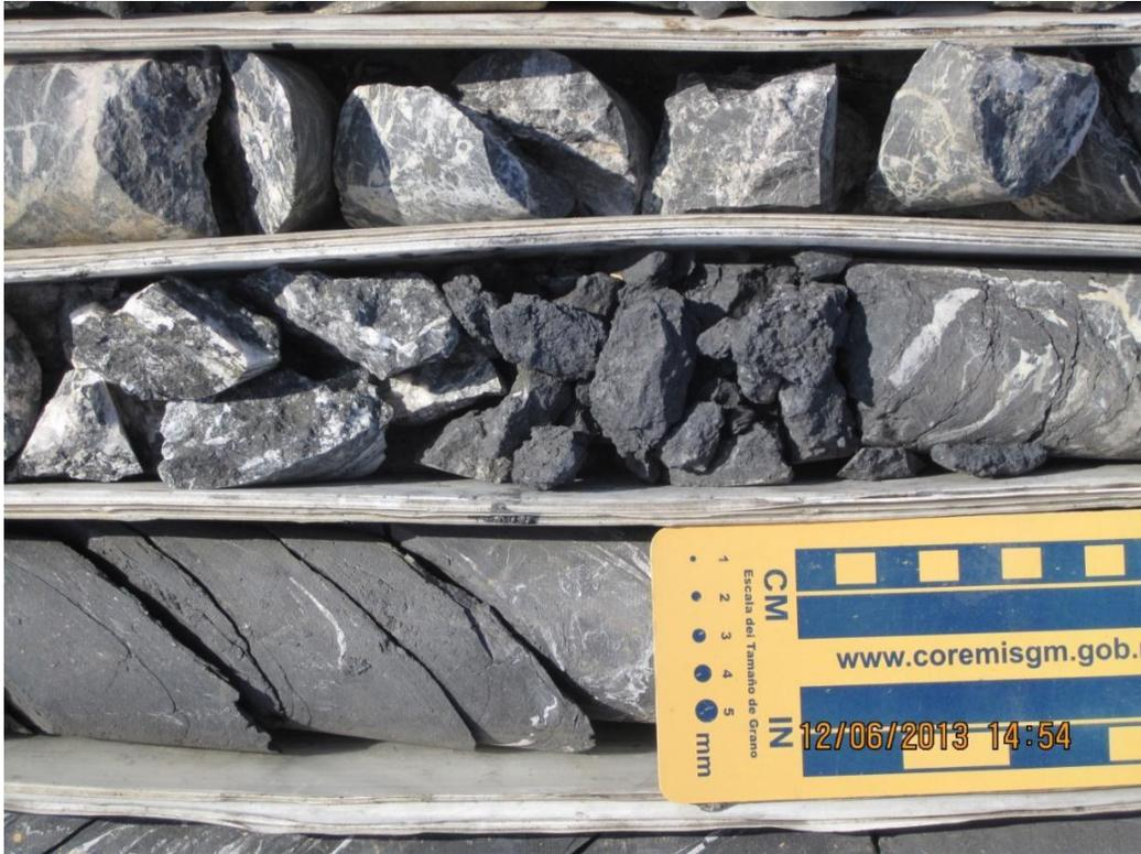
Figura 7. Muestra TN14 que consta de limolitas filíticas laminares de la Formación Chipoco.
