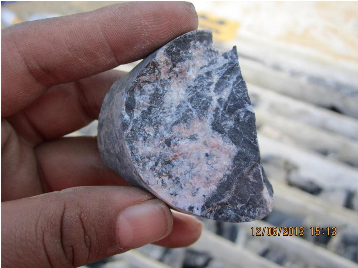
Fig. 8. Muestra TN15 correspondiente al manto manganesífero caliza de color gris claro intensamente fracturada de la parte basal de la Formación Chipoco.
