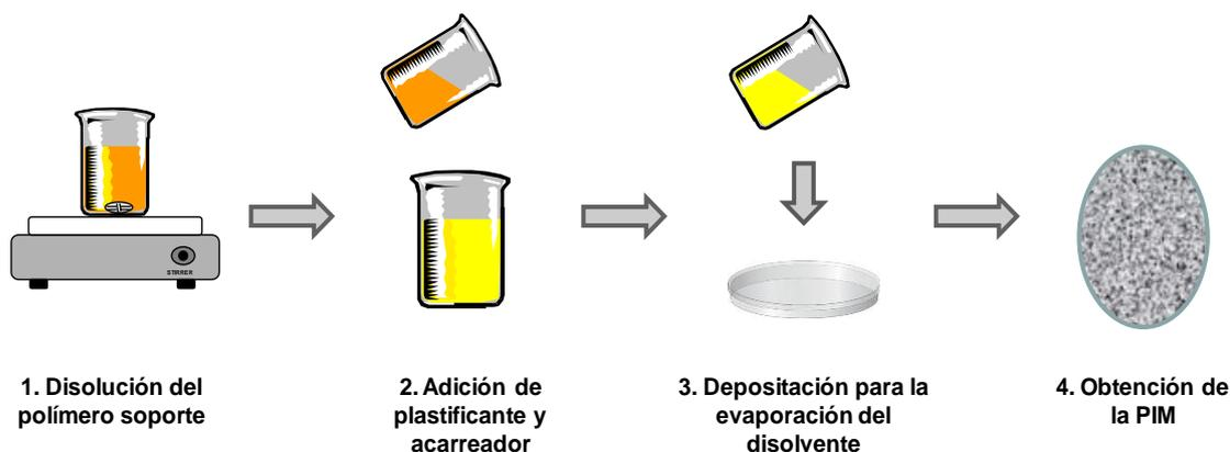
**Figura 4.4.** Esquema general para la elaboración de la membrana polimérica de inclusión (PIM)
