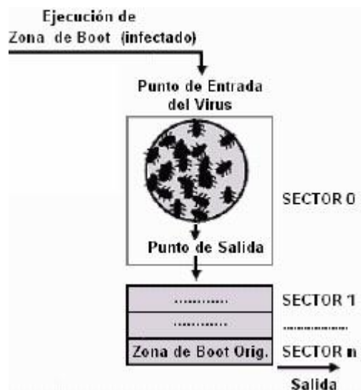
Fig. 2.4 Técnica de infección en zona de booteo.
